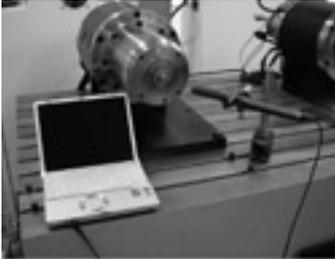
Ein Mikrophon an das Aufnahmegerät anschließen. Wir empfehlen ein Mikrophon mit gleichmäßiger Frequenzcharakteristik<sup>\*3</sup>, die eine gute Aufzeichnung von Maschinengeräuschen gewährleisten. Es sollte ein externes Mikrophon zur Geräuschmessung verwendet werden. Ein im PC integriertes Mikrophon ist zur Aufzeichnung von Stimmen geeignet jedoch nicht für die Aufnahme von Maschinengeräuschen.
