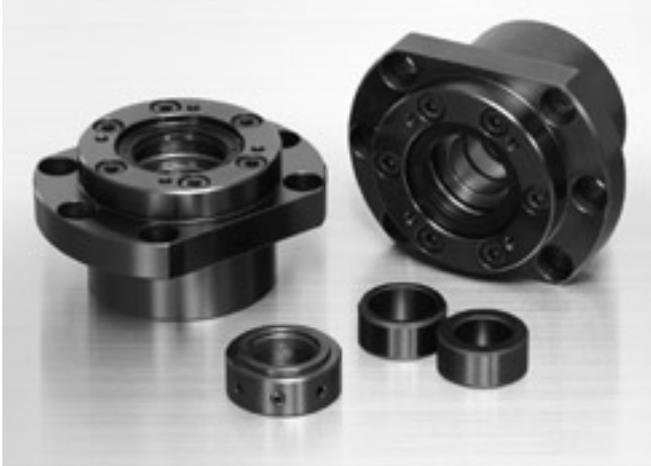
Die Lagereinheiten für hoch belastete Werkzeugmaschinen sind mit hoch genauen und extrem steifen Axialschrägkugellagern für Kugelgewindetriebe (TAC-Serie) ausgerüstet. Damit ist eine optimale Funktion als Axiallager für Kugelgewindetriebe gewährleistet. Wie in der Übersicht gezeigt, sind drei verschiedene Lageranordnungen erhältlich:
