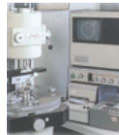
Rundheitsmessgerät mit hoher Vergrößerung (200 000-fach)
